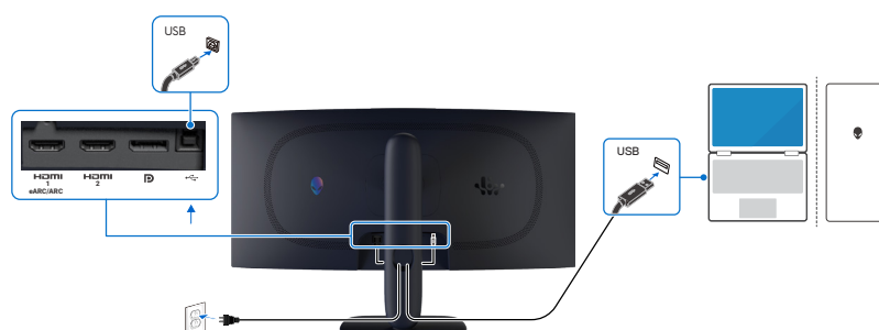
Slika 26. Povezivanje USB kabla tipa B (tip-B na tip-A).
