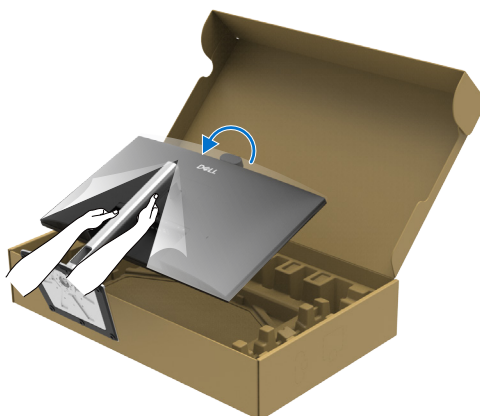
Slika 23. Držite stub stalka i podignite monitor
