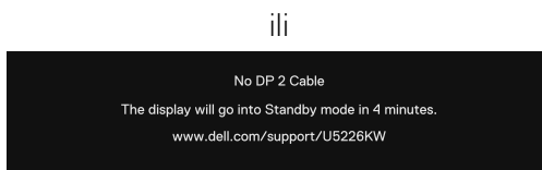
Slika 91. Poruka upozorenja - nema DP 2 kabla
