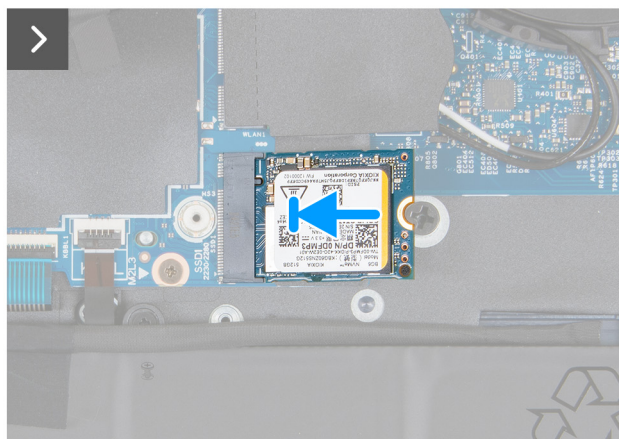
Slika 29. Postavljanje M.2 2230 SSD-a u SSD1 slot
