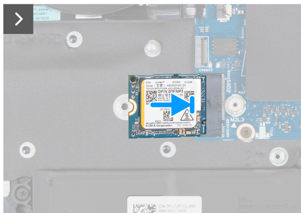
Slika 30. Uklanjanje M.2 2230 SSD-a u SSD2 slotu
