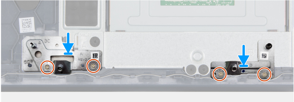
Slika 43. Postavljanje nosača baterije sa 3 ćelije
