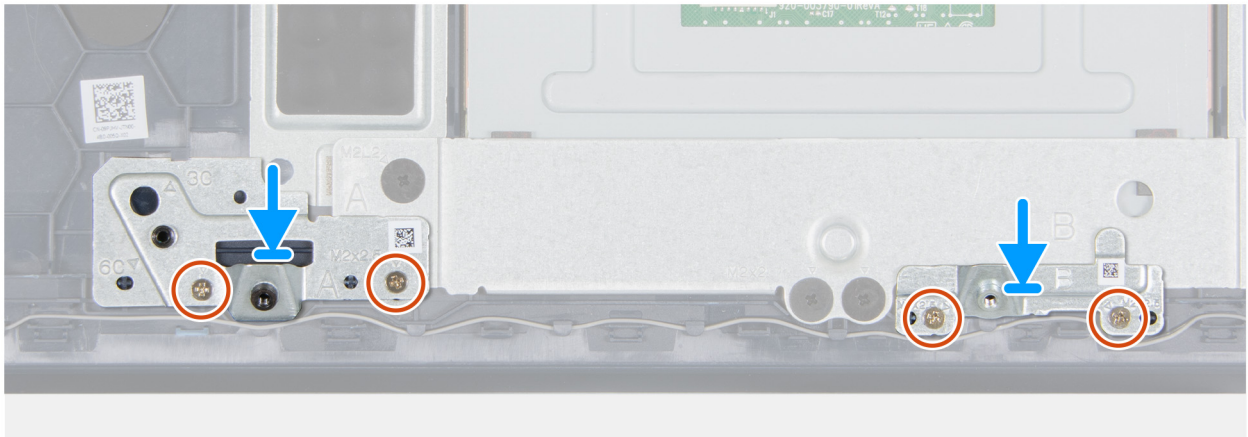
Slika 45. Postavljanje nosača baterije sa 6 ćelije
