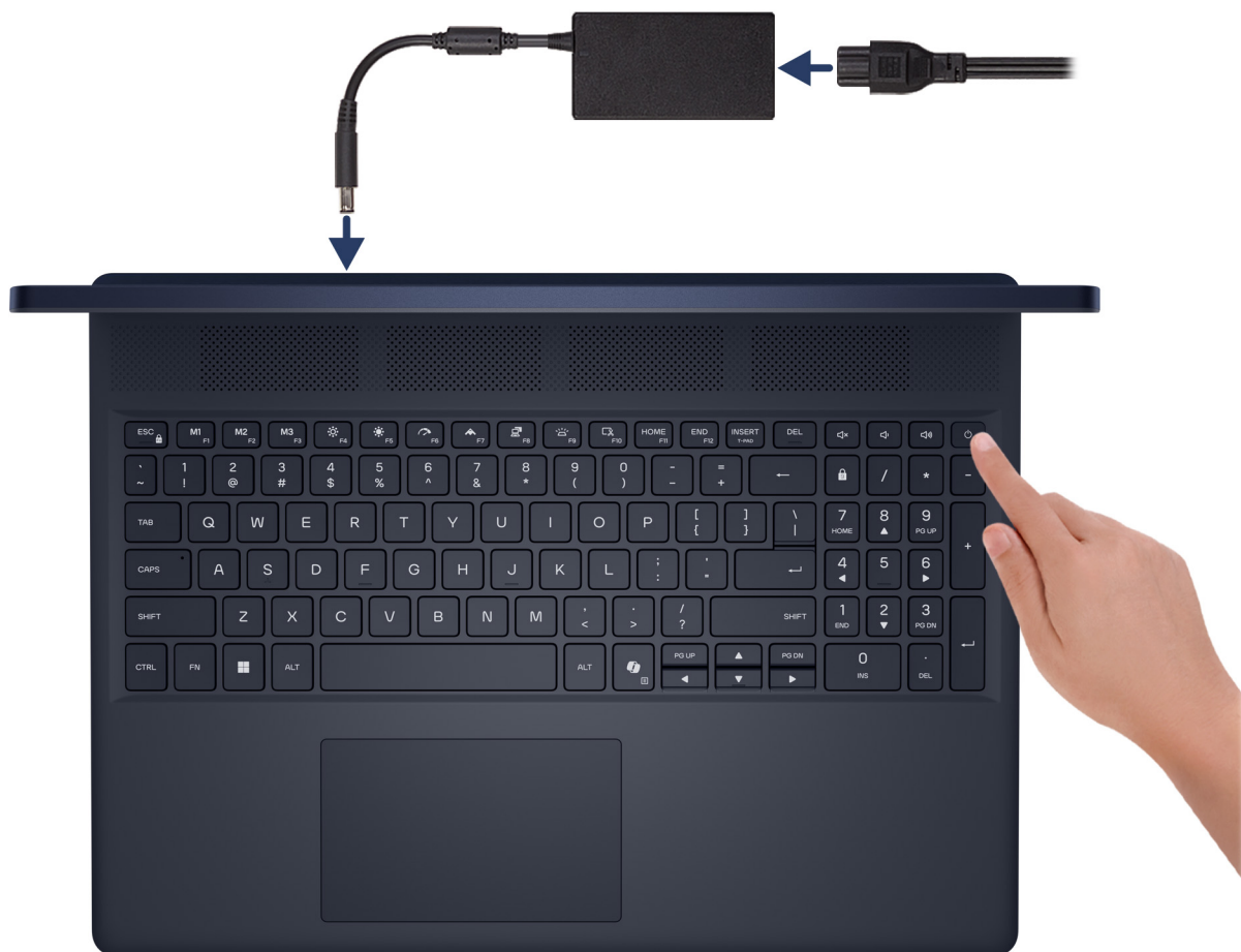
Slika 8. Povežite adapter za napajanje i pritisnite dugme za napajanje
