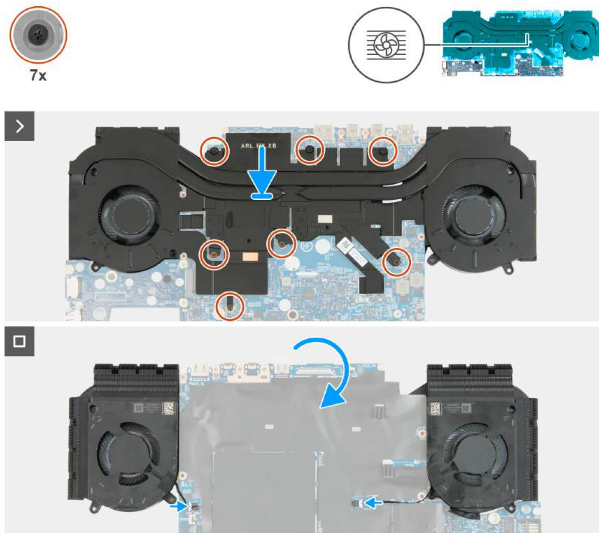
Slika 61. Postavljanje sklopa ventilatora i rashladnog elementa
