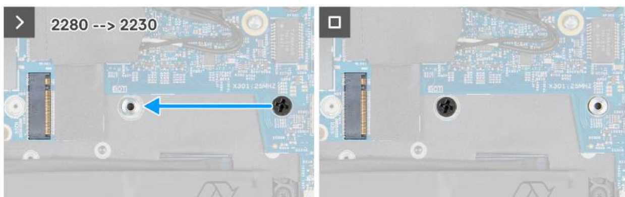
Slika 32. Postupak za pomeranje nosača zavrtnja za postavljanje M2.2230
