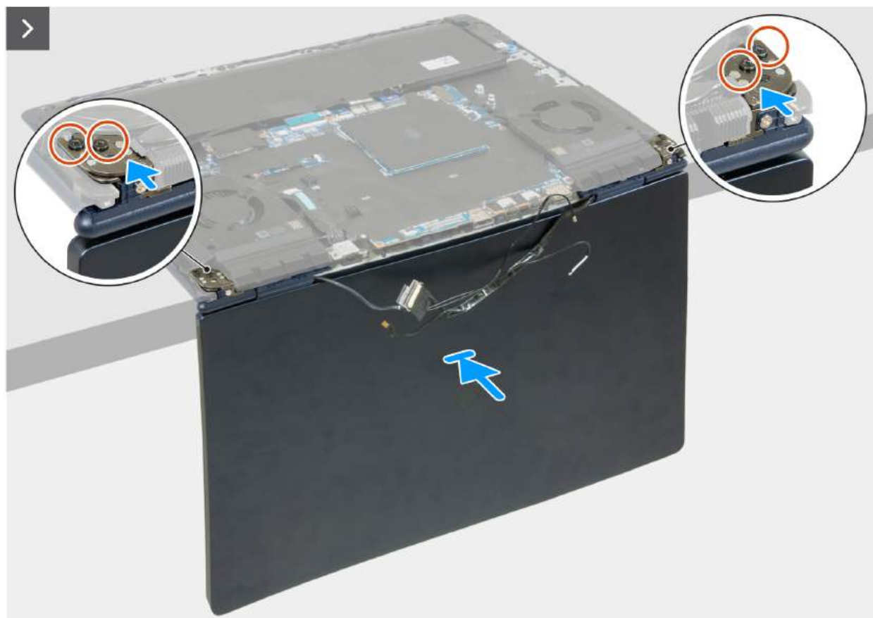
Slika 74. Postavljanje sklopa ekrana
