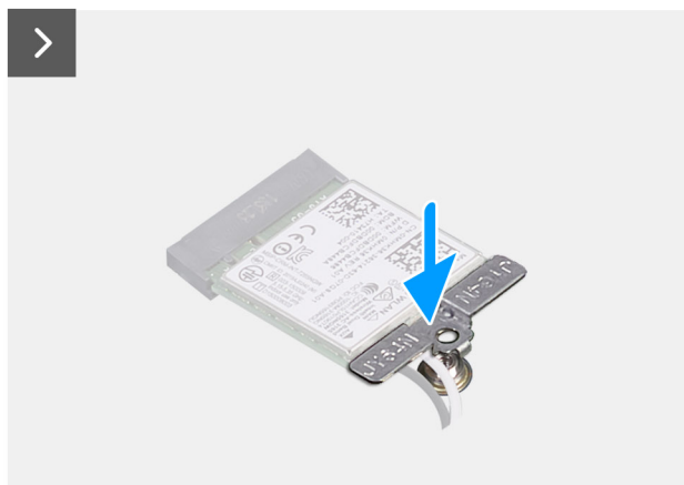
Slika 31. Postavljanje bežične kartice
