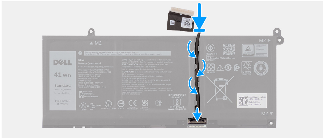
Slika 25. Povezivanje kabla baterije
