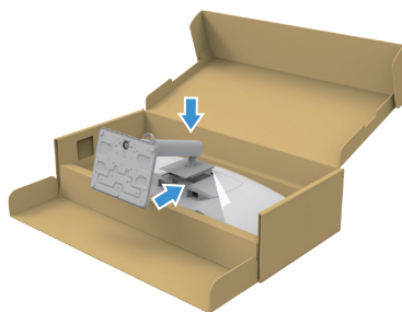
Slika 14. Prikačite sklop postolja na ekran
