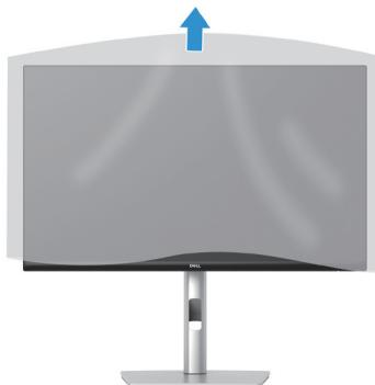
**Slika 18. Uklonite pokrivač sa monitora**
