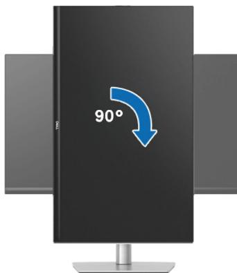
Slika 29. Rotiranje u smeru kazaljke na satu
