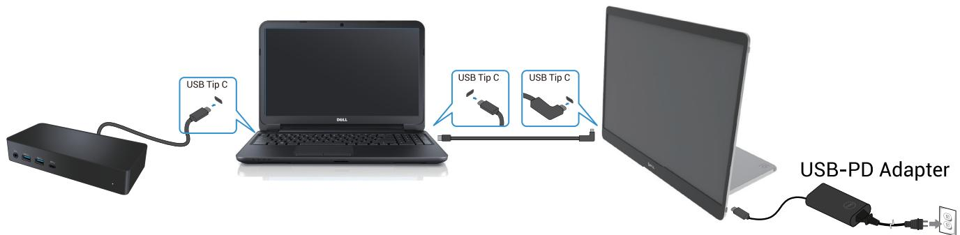
Slika 15. Upotreba sa doking uređajem (Monitor povezan sa adapterom).
