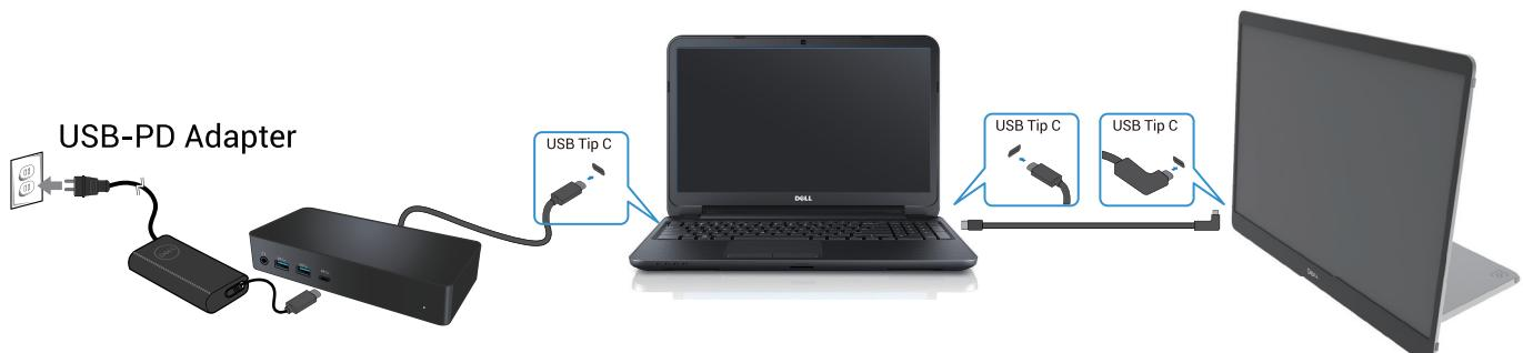
Slika 16. Upotreba priključka kod doking uređaja
