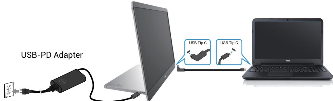
**Slika 32.** Odvojite USB Tip-C kabl za napajanje.
