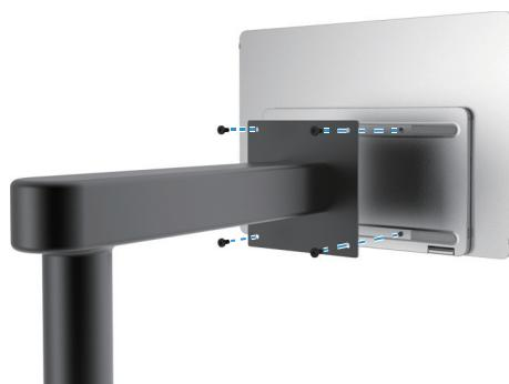
**Slika 8. Pričvrstite montažni nosač**
