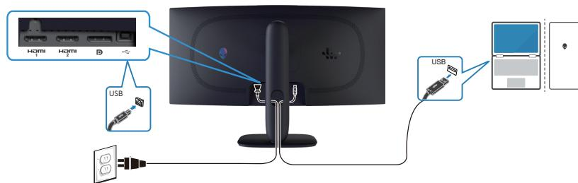
Slika 24. Povezivanje USB kabla tipa B (tip-B na tip-A).
