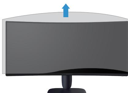
**Slika 17. Uklonite zaštitni pokrivač sa monitora**
