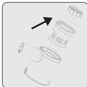
Izvucite EPA E10 i plastični držač filtera iz EPA E10 ručke.
