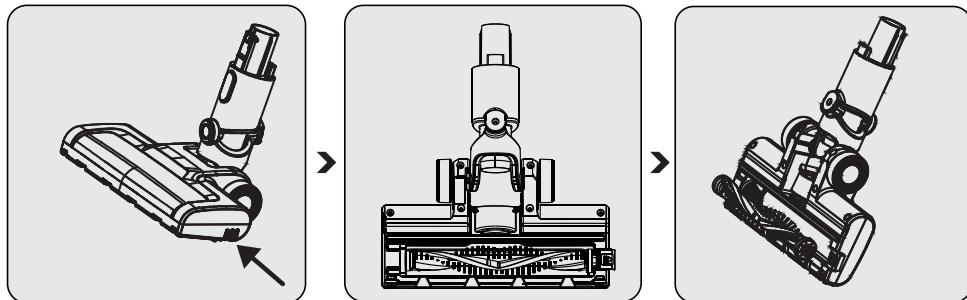
Pritisnite dugme za otpuštanje valjka. Uklonite prašinu sa njega laganim udarcem na tvrdnu površinu ili uklonite prašinu četkom. Ako se neka dlaka, itd. zapetlja, uklonite je odsecanjem.
