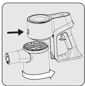
Pričvrstite priključak kante za otpatke na rupice na telu, a zatim pričvrstite kantu za otpatke okretanjem u smeru suprotnom od kazaljke na satu dok ne čujete klik.
