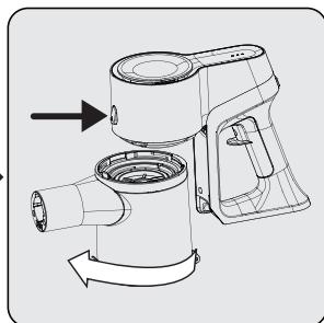
Za detaljno čišćenje filtera, uklonite posudu za prašinu okretanjem u smeru kazaljke na satu.
