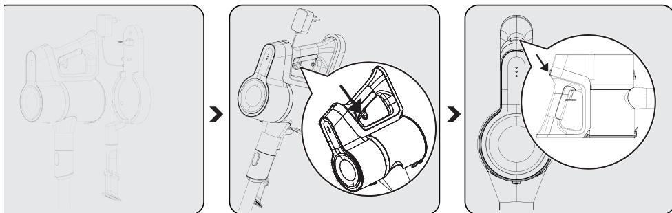
1- Pritisnite dugme za otpuštanje uređaja (7) na stanicu za punjenje (8) nadole i istovremeno povucite uređaj prema sebi. 2- Uklonite uređaj sa priključne stanice za punjenje (8).
