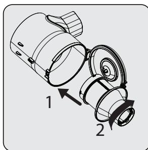
Da biste izvadili plastični filter, prvo okrenite filter suprotno od smera kazaljke na satu (1), a zatim izvadite filter (2).
