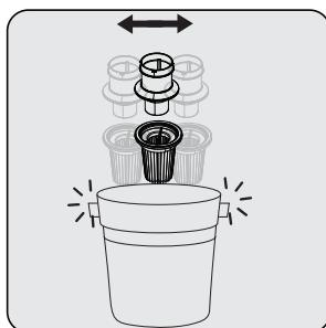
Uklonite prašinu sa pred-filtera tapajući ga o tvrdu površinu kao što je kanta za smeće ili to uradite pomoću četke.
