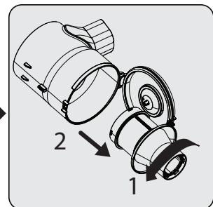
Da biste ubacili plastični filter, prvo ubacite filter (1), a zatim ga okrenite u smjeru kazaljke na satu (2).
