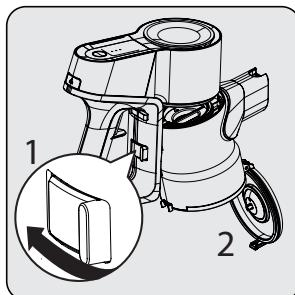
Da biste detaljno očistili filtere, uklonite posudu za prašinu pritiskom na dugme sa leve strane.
