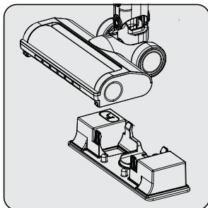
Pričvrstite priključak za krpnu na dno električne turbo četke.
