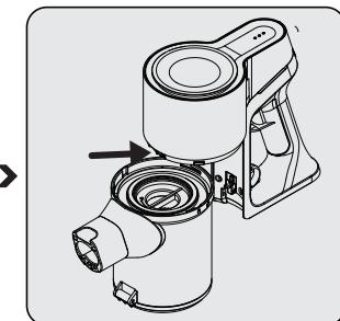
Pričvrstite priključak posude za prašinu na rupice na kućištu, a zatim podesite posudu za prašinu dok ne čujete zvuk klika.
