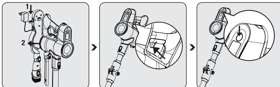
1- Pritisnite dugme za otpuštanje uređaja na priključnoj stanicu za punjenje nadole i istovremeno povucite uređaj prema sebi.
