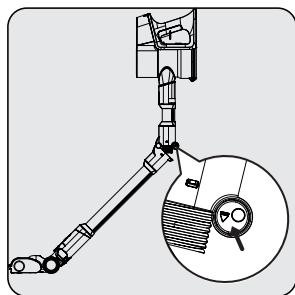
Možete preklopiti cev za lak pristup delovima kao što su fotelje i ispod stolova. Cev možete saviti pritiskom na okruglo dugme na mehanizmu koji omogućava savijanje cevi.
