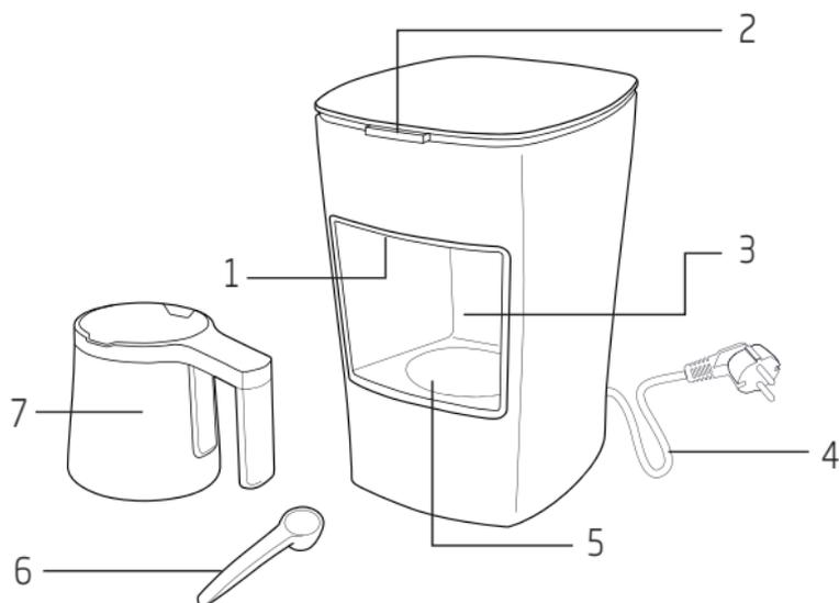
1. Senzor za detekciju nivoa kuvanja
