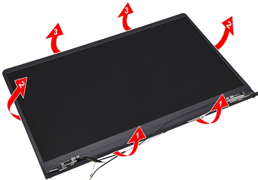
5. Podignite i uklonite okno ekrana sa sklopa ekrana.
