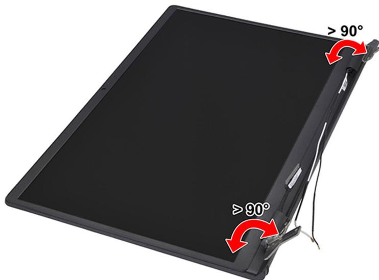
2. Pomoću plastične olovke podignite poklopac levog zgloba ekrana sa desne strane i uklonite ga sa levog zgloba ekrana.
