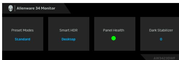
Normalno, **Panel Health (Zdravlje panela)** prikazuje zelenu tačku. Kada se prikaže žuta tačka, predlaže se da se izvrši **Pixel Refresh (Osvežavanje piksela)**; kada se prikaže crvena tačka, to znači da je monitor korišćen 20 sati bez izvršavanja **Pixel Refresh (Osvežavanje piksela)** ili 1500 sati bez izvršavanja **Panel Refresh (Osvežavanje panela)**. Za više informacija, pogledajte **OLED Panel Maintenance (Održavanje OLED panela)**.
