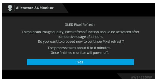
Izaberite **Yes (Da)** i proces osvežavanja će se automatski izvršiti nakon isključivanja monitora. Ovom procesu je potrebno oko 6 do 8 minuta da se završi.
