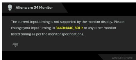
To znači da monitor ne može da se sinhronizuje sa signalom koji prima sa računara. Pogledajte [Specifikacije monitora](#) za horizontalne i vertikalne frekventne opsege koje adresira ovaj monitor. Preporučeni režim je **3440 x 1440**.
