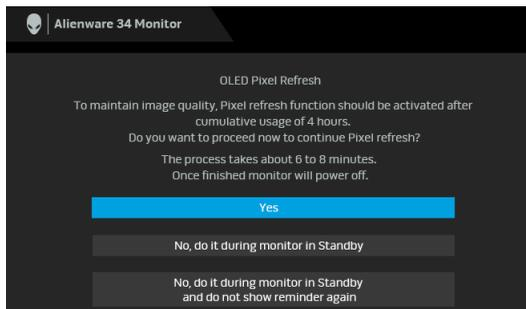
Izaberite **Yes (Da)** i proces osvežavanja će se automatski izvršiti nakon isključivanja monitora. Ovom procesu je potrebno oko 6 do 8 minuta da se završi. Kada se monitor uključi nakon 20 sata ukupne upotrebe, funkcija **Pixel Refresh (Osvežavanje piksela)** se automatski pokreće i obaveštava vas sledećom porukom:
