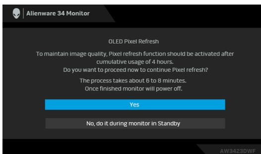
Kada izaberete **Yes (Da)**, monitor će se isključiti i proces osvežavanja biće pokrenut automatski. Ovom procesu je potrebno oko 6 do 8 minuta da se završi.
