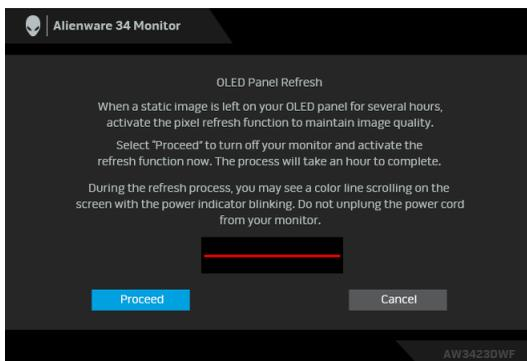
Izaberite **Proceed (Nastavi)** i proces osvežavanja će se izvršiti automatski. Ovom procesu je potrebno oko sat vremena da se završi.
